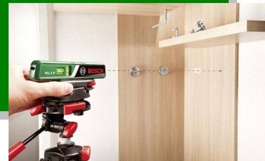
**Nivela manuală** – poate fi folosită pentru verificarea planeității (orizontal și vertical), de exemplu asezarea mașinilor de spălat rufe sau a aparatelor frigorifice
